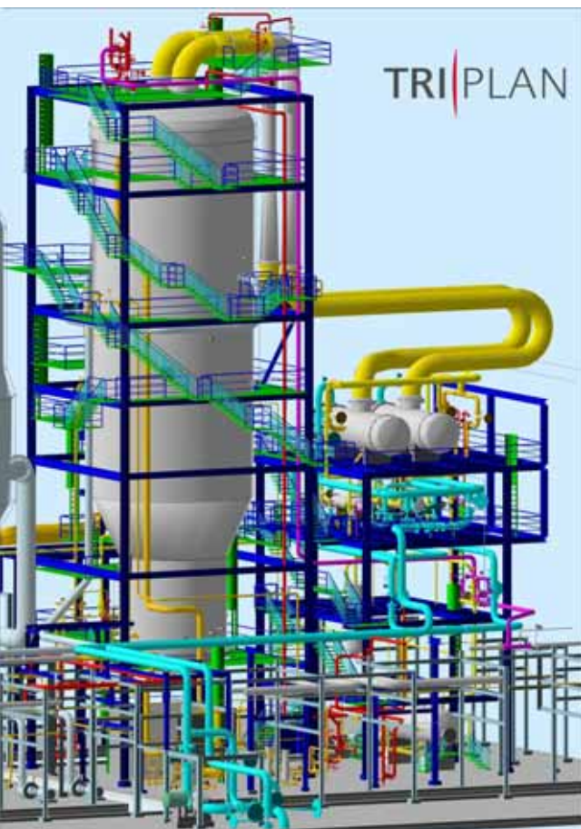
Die neue Vakuumkolonne der MiRO in Karlsruhe weist mit 8,3 m Durchmesser und 32 m Höhe ein Gewicht von 230 t auf.
